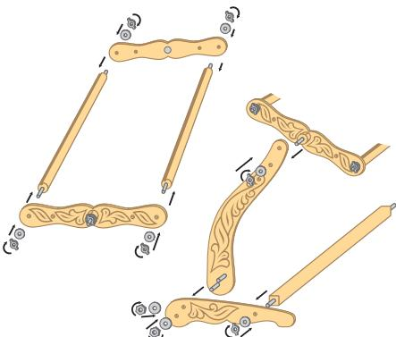
2. Соберите боковые опоры станка. Затем к одной из опор прикрепите собранную рамку и дополнительную поперечную планку. Затем прикрепите вторую боковую опору.
